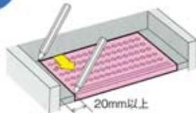
裁断した消音マットを規定の位置に仮置きし、納まりを確認した後、下地に位置決めのマーキングを記してください。
